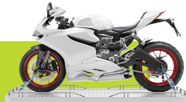
Unser EILZURR®-System ist die perfekte Lösung, um dein Bike kraftschlüssig und StVO-konform auf dem TREILER zu fixieren. Alle Federelemente bleiben frei beweglich und werden nicht gewaltsam niedergezurrt. Verkleidungsteile werden nicht beschädigt und es entstehen keine Kratz- und Scheuerstellen durch Gurte oder Metallhaken.
